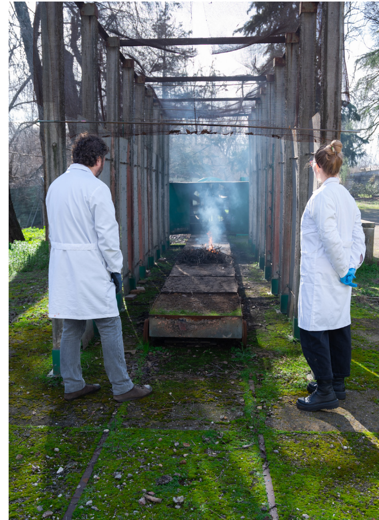
Túnel de viento del ICIFOR-INIA para ensayos a escala de planta que imitan la realidad. /CÉSAR HERNÁNDEZ
